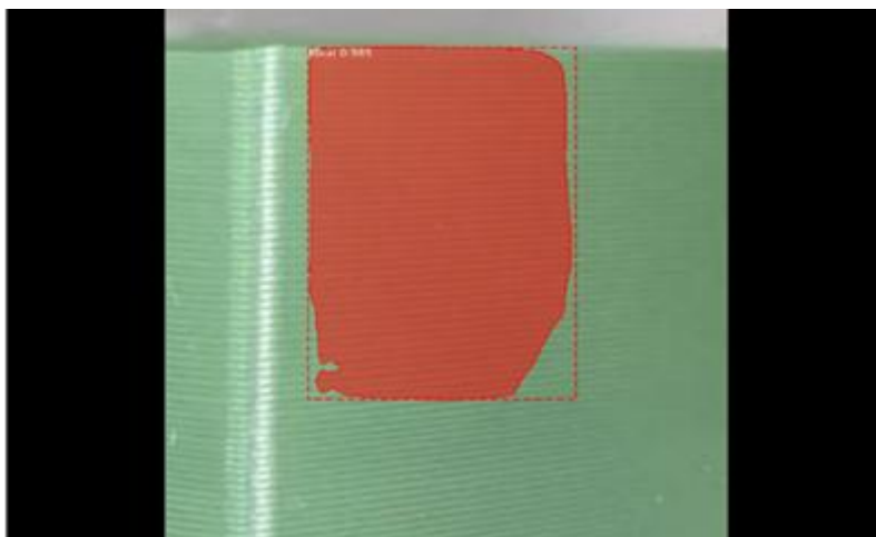
Рис. 9. Выделение эталонного участка на детали
