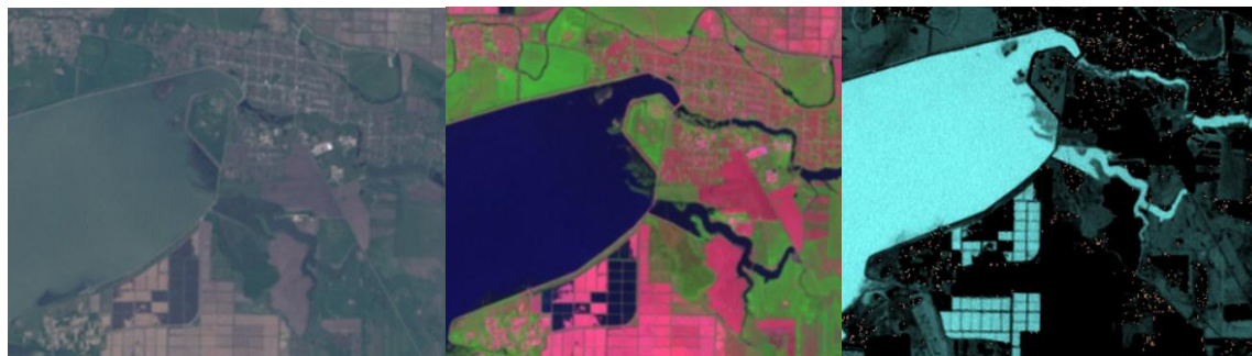
Рис. 1. Снимок Landsat-7 некоторой местности с водными объектами. Изображение слева – синтез в естественных цветах, по середине – синтез SWIR-NIR-RED, справа – с рассчитанным индексом NDWI
