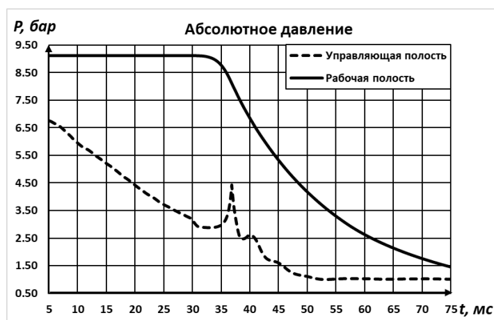
Рис. 4. Давление в рабочей и управляющей полостях
